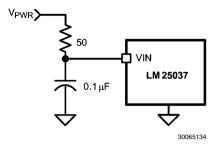
**FIGURE 10. Input Transient Protection**
