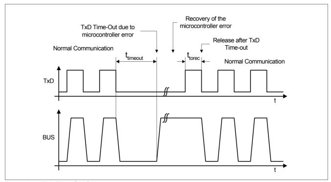
Figure 10 TxD Time-Out function
