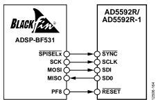
Figure 46. ADSP-BF531 SPI Interface
